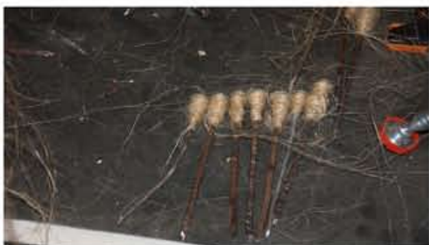
9. Owijanie gwoździ targanem, w celu uszczelnienia połączenia burtowych
