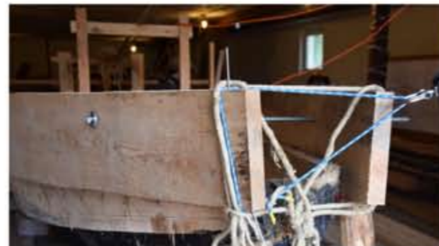
22. Kafa -miejsce zbiegu wszystkich bretów dna i burt, przygotowane pod montaż sztaby
